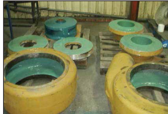
Dos bombas nuevas protegidas con ARC.
